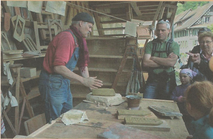
Handziegeln. 2014 stellte uns Richard Bucher, der letzte Handziegler der Schweiz, sein Kunsthandwerk vor. Aus Lehm aus nächster Umgebung entstanden kunstvolle Ziegel und Bodenplatten.
