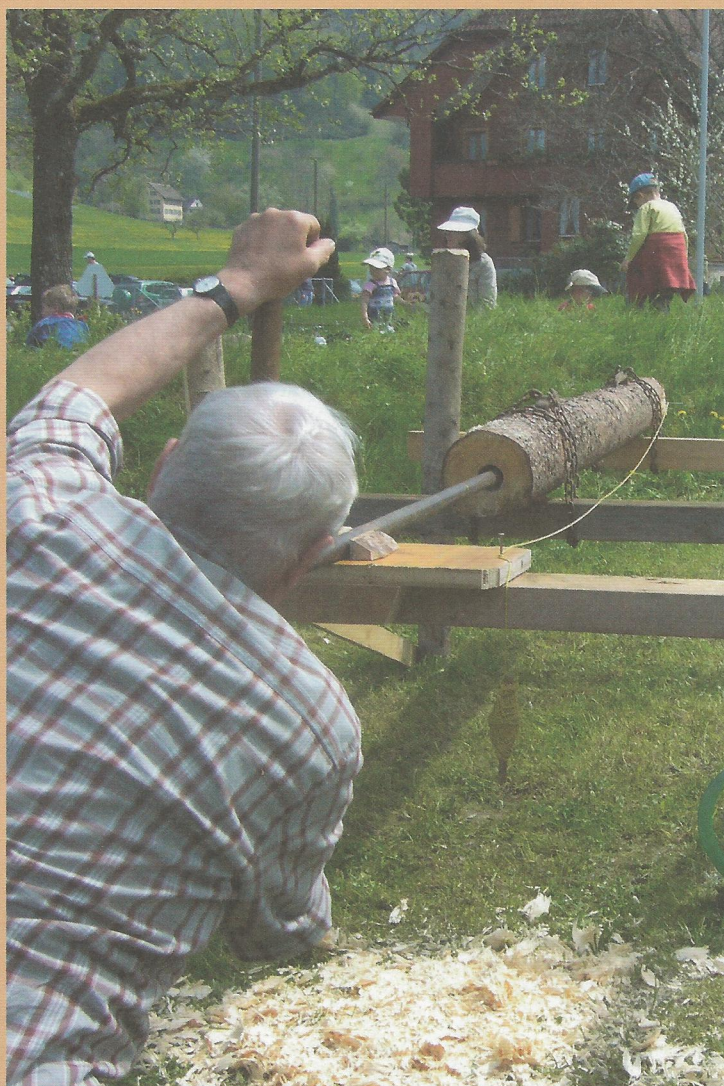
Tüchel bohren. Vor vielen Jahren wurden auch für die Aumüli Tüchel verwendet, durchbohrte Baumstämme, die als Wasserleitungen dienten. Am Mültag 2008 demonstrierte Günter Werren das anspruchsvolle Handwerk des Tüchelbohrers.
